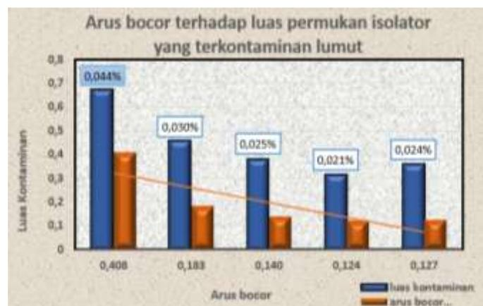
**Gambar 3. Arus Bocor Terhadap Luas Permukaan Isolator Yang Terkontaminasi Lumut**
